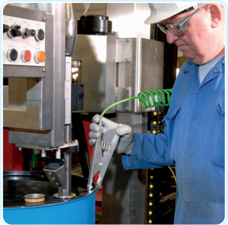
Le pinze Cen-stat sono progettate per penetrare attraverso rivestimenti, depositi induriti di prodotto, ruggine e sporco per consentire connessioni a bassa resistenza per dissipare in sicurezza eventuali cariche elettrostatiche
